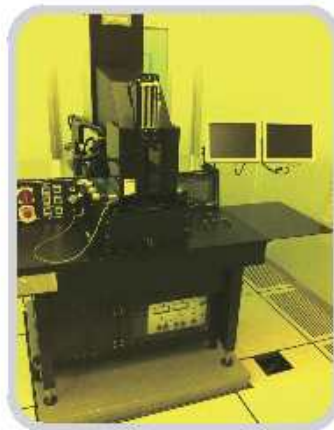
雙面對準單面曝光機(Back Side IR/Visible)
